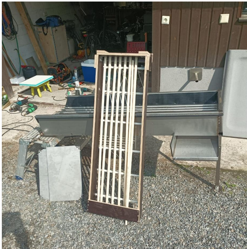
Kuva 3. Rapujen lajittelulaitteen kehitysversiot: testimalli edessä pystyttyssä ja lopullinen mallilaite sen takana.
