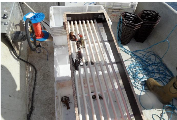
Kuva 2. Testimalli veneessä rapuineen, lajittelu toimii!
