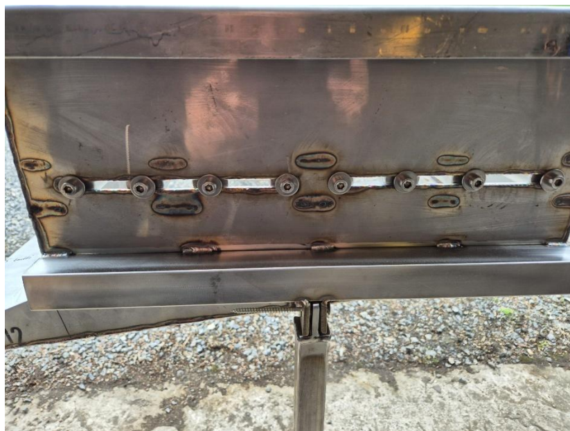
Lajittelulaitteen yläpään säleikön rakovälin säätö kuusikolopultein.
