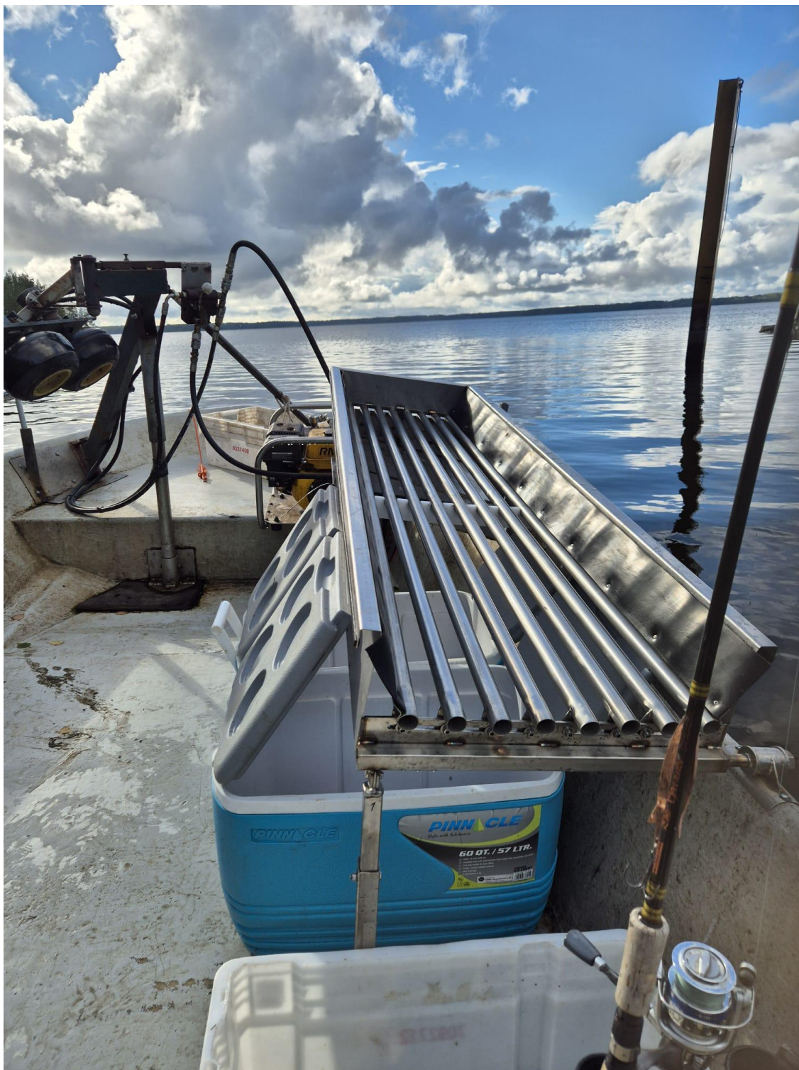
Lajittelulaitteen prototyyppi veneeseen kiinnitettynä. Lajittelulaitteen alla säilytyslaatikot, joihin voi laittaa kylmävaraajat, tuulelta ja auringolta suojaavat muovisäkit ja muun rapujen kuljettamisen ja säilyttämisen kannalta oleellisen varustelun.
